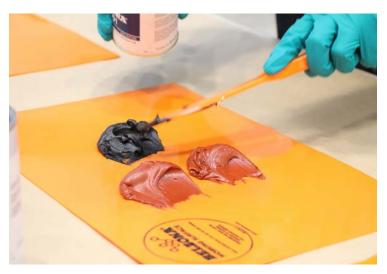
Для смешивания небольших количеств Belzona® 4301 берут 2 части основы на 1 часть отвердителя по объему.
