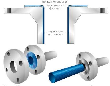
Belzona 4301 подходит для восстановления опорных поверхностей фланцев и изготовления втулок для патрубков
