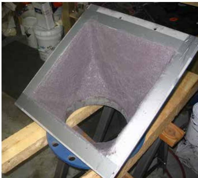
Belzona 1812 (Ceramic Carbide FP) — двухкомпонентное покрытие для ремонта и защиты поверхностей, контактирующих с абразивными средами.
