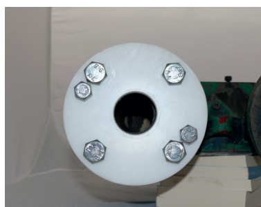
УСТАНОВЛЕНА ФОРМА С МАТЕРИАЛОМ BELZONA
