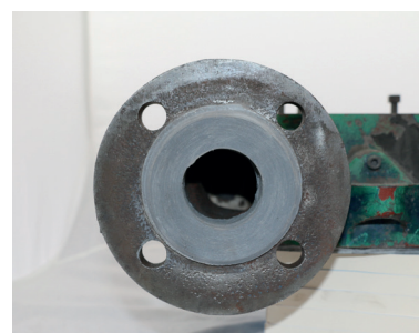
ФОРМА СНЯТА, ВИДНА ВОССТАНОВЛЕННАЯ ОПОРНАЯ ПОВЕРХНОСТЬ
