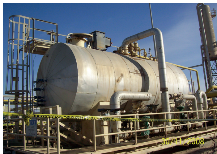
Belzona 5892 использовали для футеровки обессоливателя
