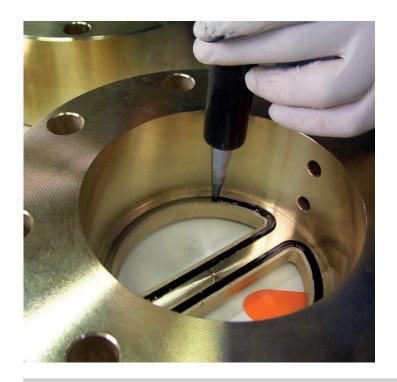
Belzona 2131 (D&A Hi-Build Elastomer) — двухкомпонентная полиуретановая смола, предназначенная для нанесения покрытий на металлические и резиновые поверхности, а также для изготовления резиновых деталей методом литья.
