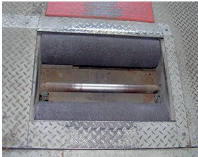
Приводные барабаны через 12 лет после нанесения покрытия по-прежнему в отличном состоянии
