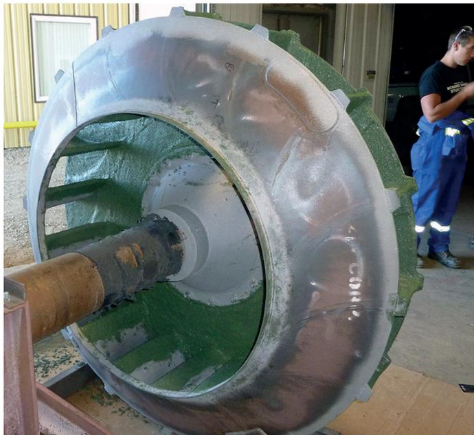
Belzona 1813 — двухкомпонентное покрытие для защиты и ремонта поверхностей, контактирующих с абразивными средами при повышенных температурах до 200 °С.
