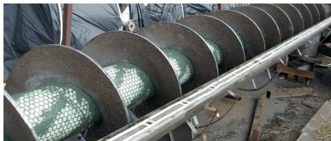
После восстановления с помощью Belzona 1813 и алюмооксидной плитки
