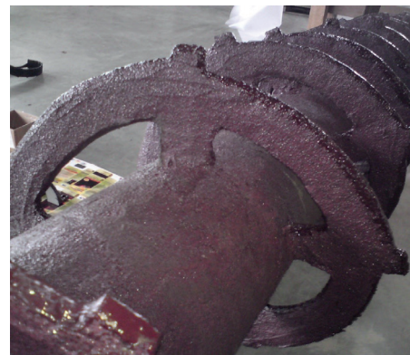
Нанесено покрытие Belzona 1811
