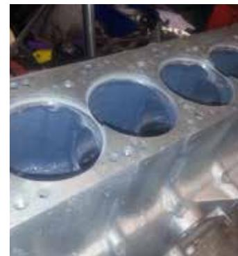
Защитное покрытие блока цилиндров
