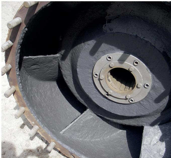
Belzona 1311 (Ceramic R-Metal) — ремонтный композит, предназначенный для восстановления металлических компонентов и для защиты их от эрозии и коррозии.
